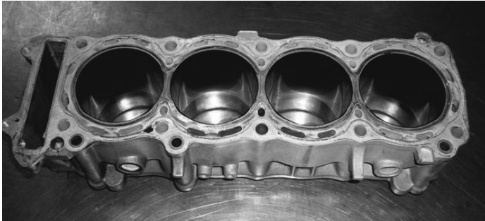
Bild 8: F6399 beschichteter und gehonter 4-Zylinder Block wie er für die Motorenversuche verwendet wurde
