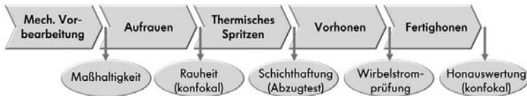
Bild 8: Qualitätsprüfungen in der Prozesskette Plasmaspritzen
