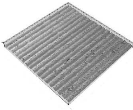
Bild 9: 3D-Topografie Laserstrahlaufrauen mittels Konfokalmikroskopie
