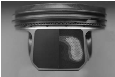
Bild 4: Gegenüberstellung der Simulation der im Motor gelaufenen Schaftbeschichtung (links) und des Kontaktdruckes (rechts).
