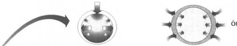
Bild 1: Sogwirkung durch elastische Verformung Pleuelbolzen
