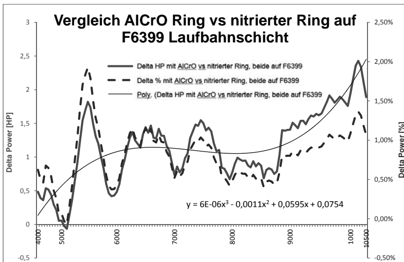
Bild 9: Vergleich der gemessenen Differenz in der abgegebenen Motorleistung. Oben: AlCrO Ring zusammen mit F6399 Lauffläche, im Vergleich zur Baseline (nitrierter Ring mit Nikasil). Unten: AlCrO-Ring im Vergleich zum nitrierten Ring, beide auf der F6399 Lauffläche
