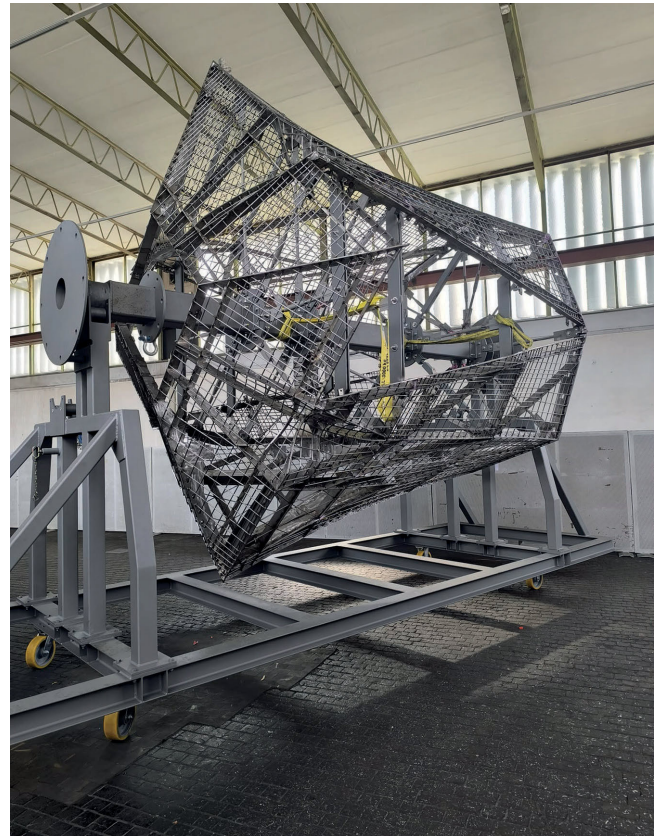
Bild 15. Stahlbau eines horizontalen Armes mit Duplex Stahl und Chromstahlbewehrungsnetz inklusive des drehbaren Transportgestells Foto: Josef Gartner GmbH Fig. 15. Steel Works of a Horizontal Arm made of Duplex-Steel and Stainless Steel Reinforcement incl. rotating transport frame Source: Josef Gartner GmbH
