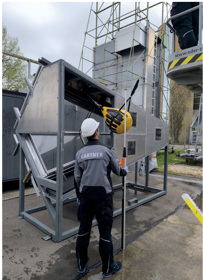
Bild 12. Test zu weichem Aufprall der Glaskonstruktion von Innen
