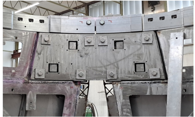
Bild 16. Gekrümmte Verbindungsplatte (2) und den Säulen des Fusts mit Zugbolzen (1) und Schubknaggen (3)
