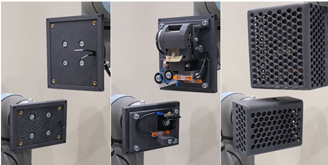
Bild 8 links: Adapterflansch UR auf Funktionsmodul, mitte: montierter Endeffektor, rechts: montierter Endeffektor mit aufgestecktem Gehäuse. Foto: wbk10
