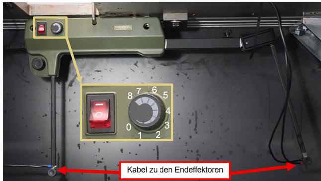
Bild 5 „Proxxon Heißdraht-Schneidebühl Termocut 650“ im eingebauten Zustand. Foto: wbk8
