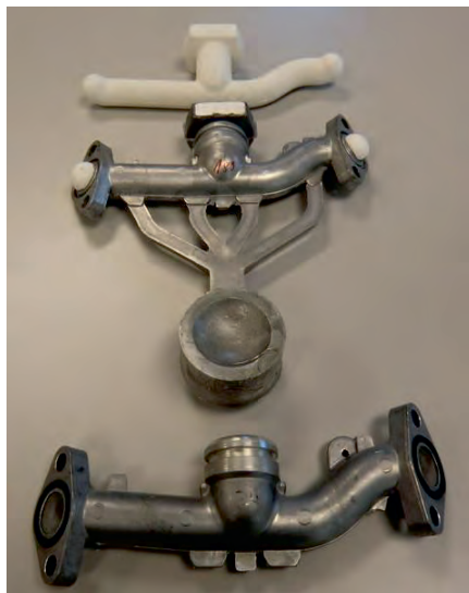
Abbildung 15: Wasserauslassstutzen aus Aluminium Druckguss unter Verwendung eines Salzkerns [37]
