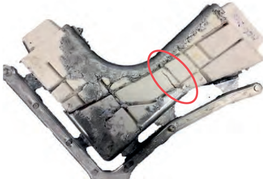
Abbildung 132: Teilweises Füllen der Form um den Versagenszeitpunkt der Salzkerne zu bestimmen
