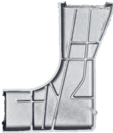
Abbildung 111: Analyse eines defektfreien Aluminiumdruckgussbauteils mittels 3D-Computertomographie
