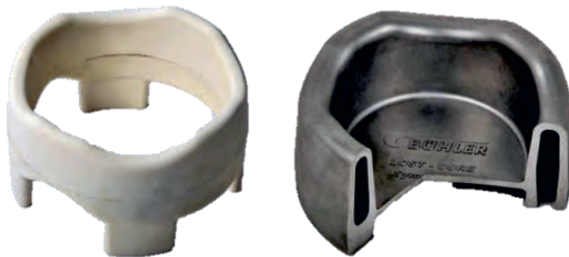
Abbildung 16: Salzkern und Demonstratorbauteil der Fa. Bühler [23]
