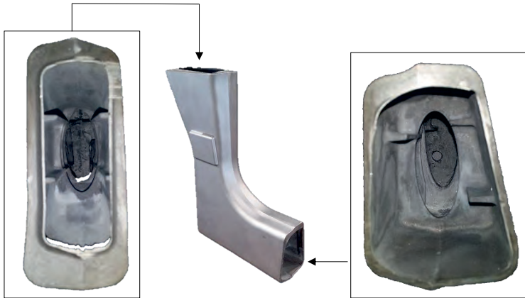
Abbildung 110: Defektfreies Aluminiumgussbauteil das im Druckguss hergestellt wurde
