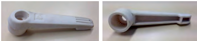
Abbildung 24: Salzdemonstrator „Hebel“ im Warmkammverfahren hergestellt [9]
