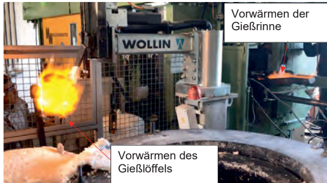
Abbildung 47: Vorwärmen des Gießlöffels und der Gießrinne mit Gasheizung
