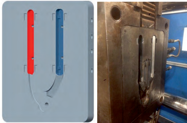
Abbildung 37: Auswerferseite des Druckgießwerkzeugs für 3-Punkt-Biegeproben
