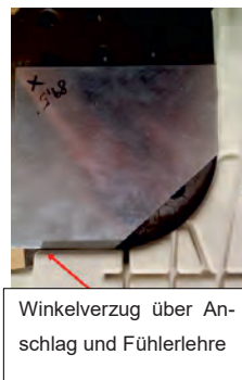
Abbildung 87: Messung des Winkelverzuges über einen Winkelanschlag und Fühlerlehre
