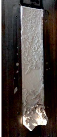
Abbildung 48: Aufgeplatzte Salzplatte nach 50s Abkühlzeit in der Druckgießform
