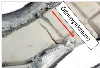
Abbildung 133: Detailaufnahme des Rissverlaufs
