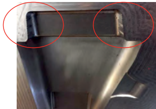
Abbildung 98: Rillenstruktur an der Oberfläche der Kernlager im Umgusswerkzeug zur Fixierung der Salzkern während des Umgießprozesses
