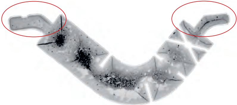
Abbildung 73: Analyse des Salzkerne „Rippenstruktur“ mittels 3D-Computertomographie
