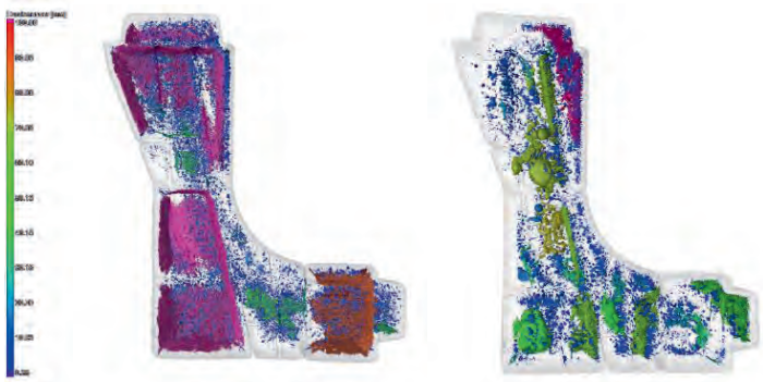
Abbildung 93: Vergleich des Defektvolumens eines untereutektischen Salzkerns (links) mit einem eutektischen Salzkern (rechts)
