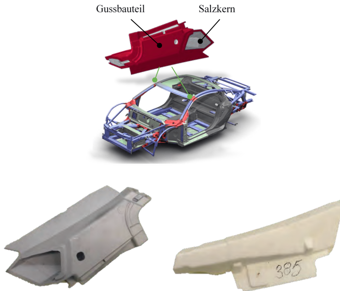
Abbildung 26: Dachknoten Lamborghini Huracan, Salzkerne und Gussteil [32], [41]
