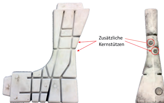
Abbildung 135: Zusätzlich aufgebrachte Kernstützen auf der Anschnittseite des Salzkerns
