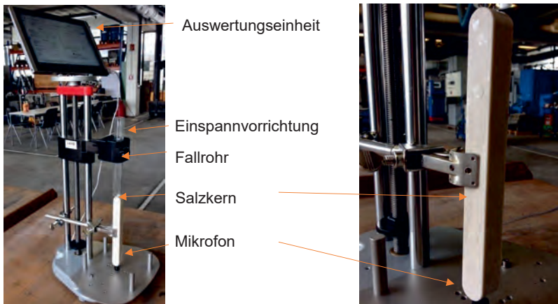
Abbildung 53: Aufbau des Prüfstandes zur Ermittlung des dynamischen E-Moduls mittels Resonanzfrequenzmethode [62]
