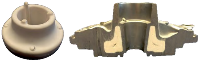
Abbildung 17: Salz Kern und Druckgussteil mit Salz Kern im Schnitt
