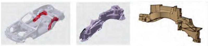
Abbildung 21: Karosserie, Strukturbauteil und Sandkern des neuen Mercedes SL [39]
