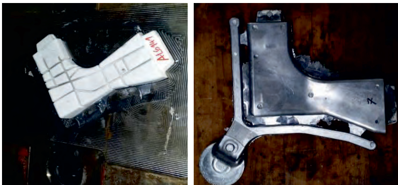
Abbildung 99: Eingelegter Salzkern im Druckgießwerkzeug auf der linken Seite und Umgussteil auf der rechten Seite
