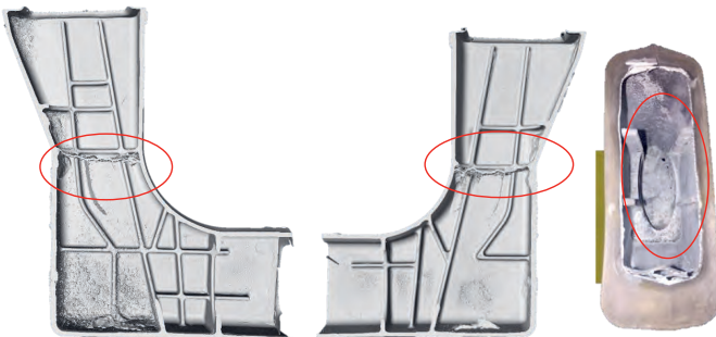
Abbildung 85: Darstellung von Defekten mittels 3D-Computertomographie (links) Druckgussdemonstrator "A-Säule" mit Defekt aufgrund eines gebrochenen Salzkerns (rechts)
