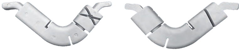
Abbildung 65: Abguss eines Demonstratorsalzkerne "Rippenstruktur" der im Druckgießverfahren hergestellt wurde
