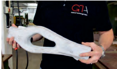
Abbildung 22: Hohler Demonstrator Großkern für mögliches Strukturbauteil [22]
