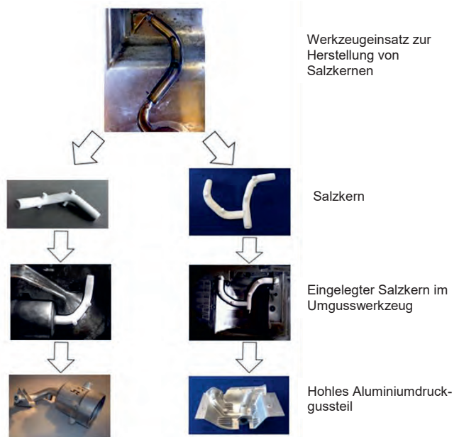
Abbildung 18: Salzkerne- Umgusswerkzeuge und Druckgussteile [21]
