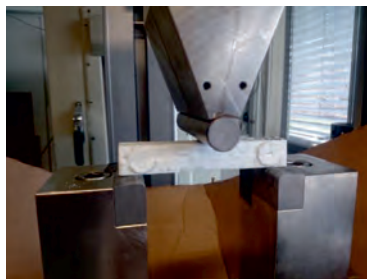
Abbildung 34: 3-Punkt-Biegeversuch der Salzproben, die im Kokillenguss hergestellt wurden
