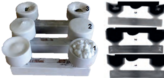
Abbildung 33: Linke Seite: Salzproben, rechte Seite: Röntgenaufnahme zur Porositätsbewertung (1) 60% KCl + 40% \text{Na}_2\text{CO}_3 (2) 40% KCl + 60% \text{Na}_2\text{CO}_3 (3) 20% KCl + 80% \text{Na}_2\text{CO}_3
