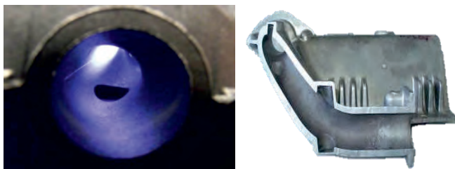
Abbildung 19: Oberflächenbeschaffenheit der Hohlstruktur im Druckgussteil im Bereich des Salzkerne [21]
