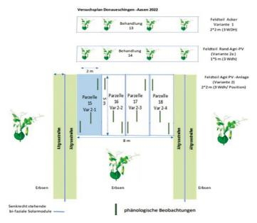
Abbildung 19: Schematische Darstellung des Versuchsaufbaus in Donaueschingen 2022.
