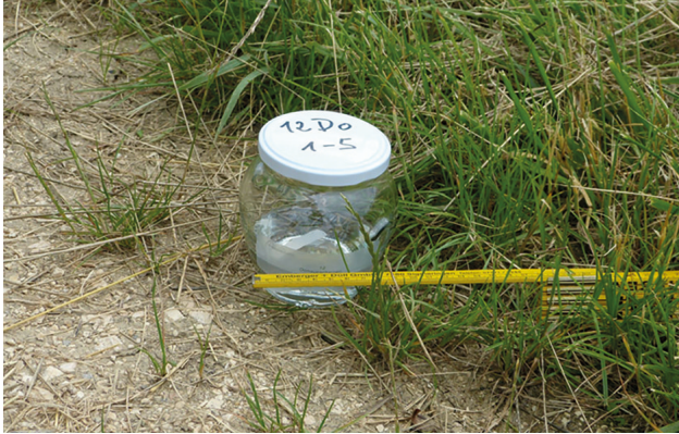
Abbildung 30: Weithalsglas mit „Renner Fanglösung“ vor dem Einbau (Parzelle 12, Donaueschingen, Variante 1 = Acker, Position 5)
