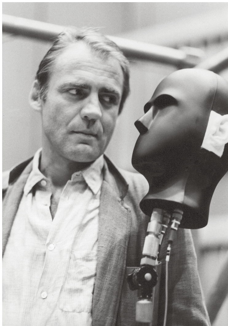
ABB.14 ► Bruno Ganz während der Aufnahmen zum Hörspiel In der Strafkolonie . Zu sehen ist der Kunstkopf, dem anstelle von Trommelfellen Mikrofone eingesetzt wurden.
