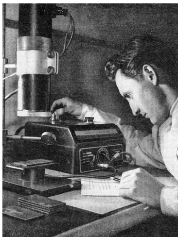
Abb. IV.2: Bestimmung der Dicke von Lackschichten durch Rückstreuungsmessungen mit ^{204}\text{Thallium}
