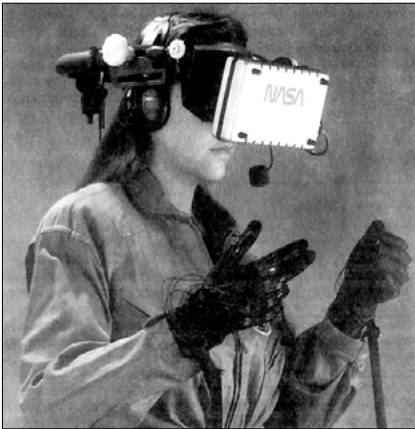
Abbildung 33 HMD des VIEW-Systems der NASA, aus: BORMANN 1994: 80.
