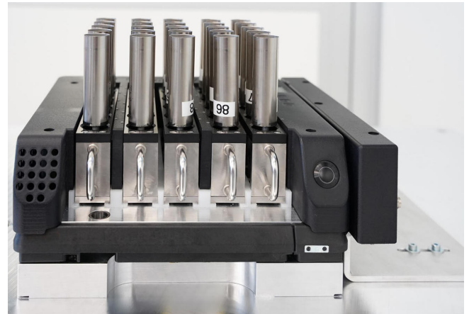
Bild 5. (a) Messsystem, ausgefahren zum Messen, mit Koppler zum Laden des Werkstückträgers und Registrieren per NFC (Near Field Communication); (b) Werkstückträger auf Messsystem in geladener Position zum Messen. Foto: Fraunhofer IPA
