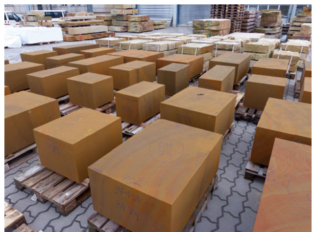
Abb. 14 Auf Maß gesägte Blöcke von Lauchheimer Eisensandstein im Hof der Bamberger Natursteinwerke H. Graser, fertig zum Abtransport in die Ulmer Münsterbauhütte. Weil sowohl in Baden-Württemberg als auch in Bayern kein Eisensandsteinbruch mehr in Betrieb war, wurde vom LGRB im Auftrag der Münsterbauhütte eine geeignete Lagerstätte erkundet, aus der die Blöcke gewonnen werden konnten. Foto: Wolfgang Werner, Jan. 2015
