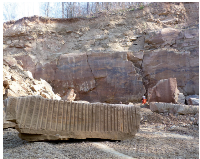
Abb. 8 Gewinnung von Heilbronner Schilfsandstein im östlich von Heilbronn gelegenen Steinbruch Winterhaldenhau der Fa. Harald Holz. Foto: Wolfgang Werner
