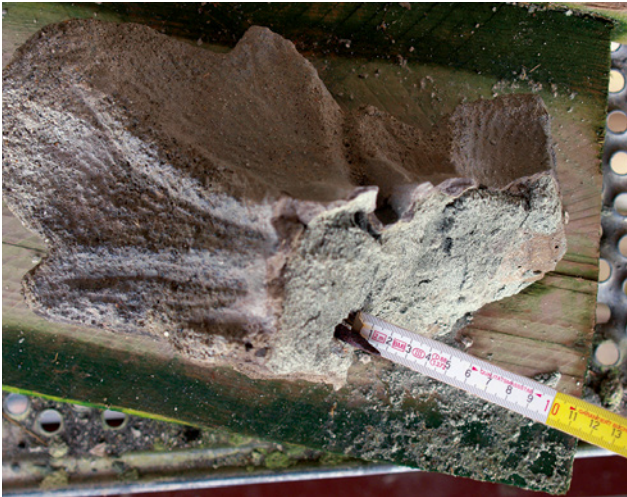
Abb. 13 Befund: Offensichtlich ungenügende Bewehrung einer früheren Kunststeinantragung, der Bruch weitgehend im historischen Steinkern
