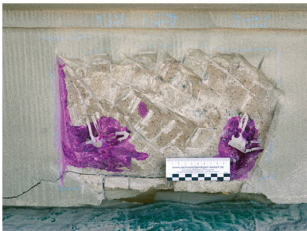
Abb. 8 Zeigt die Kontrolle des alkalischen pH-Werts an frisch freigelegten Antragsmassen: erst ab ca. 1 cm Tiefe, um einen Kunststoffanker, ist der Zement intakt, der erste Zentimeter ist karbonatisiert, Mittelbau Nordseite
