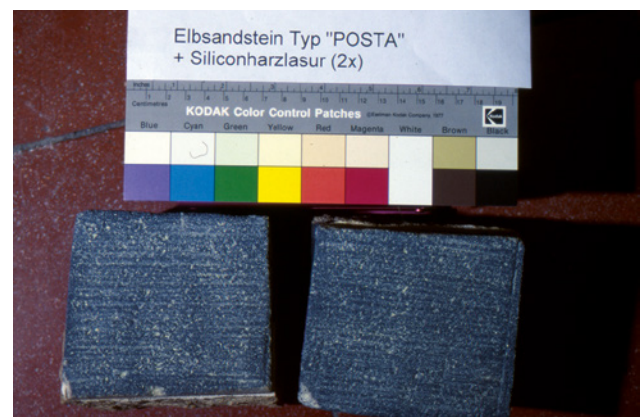
Abb. 5 „Patinierter“ Elbsandstein (Varietät Posta), nach zweimaligem Anstrich mit Siliconharzlasur (Prüfkörper Wasserabsorption)
