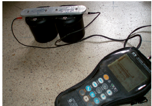
Abb. 2 Verwendetes zerstörungsfreie Prüfverfahren Ultraschallecho, Ankopplung ohne Koppelmittel
