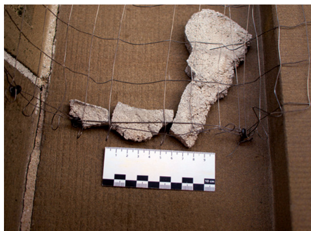
Abb. 4 Herausgefallener Fugenmörtel der 1980er Jahre von einem Gesimsprofil, aufgefangen von einem Taubenabwehrnetz am Mittelbau
