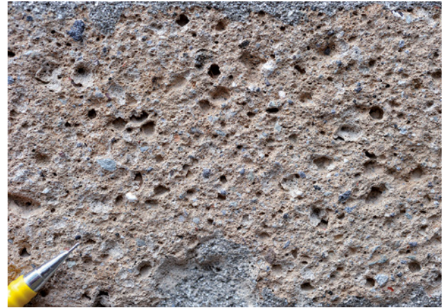
Abb. 2 Mögliche Struktur einer Tuffoberfläche. „Öffnungen“ > 0,3 mm, die nicht von einer hydrophoben Imprägnierung überbrückt werden können, sind häufig zu beobachten.
