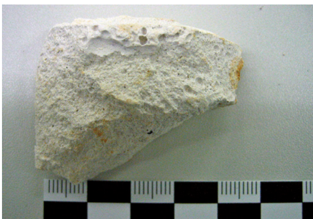
Abb. 10 Historischer Gipsmörtel (Probe E II 10) aus dem abgebauten Alabastergrabmal mit bräunlichen Verfärbungen durch die Metallkorrosion
