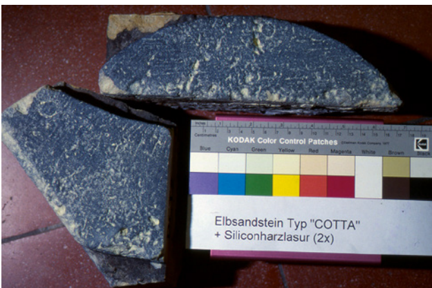
Abb. 4 „Patinierter“ Elbsandstein (Varietät Cotta), nach zweimaligem Anstrich mit Siliconharzlasur (Prüfkörper Wasserabsorption)
