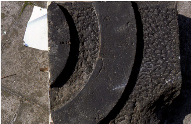
Abb. 2 „Patinierter“ Elbsandstein (Varietät Cotta), Material für die Laboruntersuchungen
