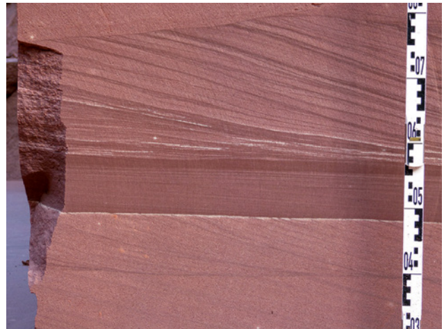
Abb. 7 Mit der Schwertsäge freigelegter Tennenbacher Sandstein im neuen „Münstersteinbruch“ bei Tennenbach, Krs. Emmendingen. Foto: Wolfgang Werner
