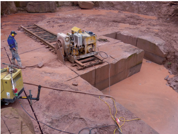
Abb. 6 Abbau von Buntsandstein in einem wieder in Betrieb genommenen historischen Buntsandsteinbruch bei Tennenbach (Krs. Emmendingen), nördlich von Freiburg. Abbauspuren belegen, dass der Bruch schon im Mittelalter betrieben wurde. Gewinnung von Rohblöcken im November 2014 durch die Fa. Lauster Steinbau, Stuttgart. Foto: Wolfgang Werner
