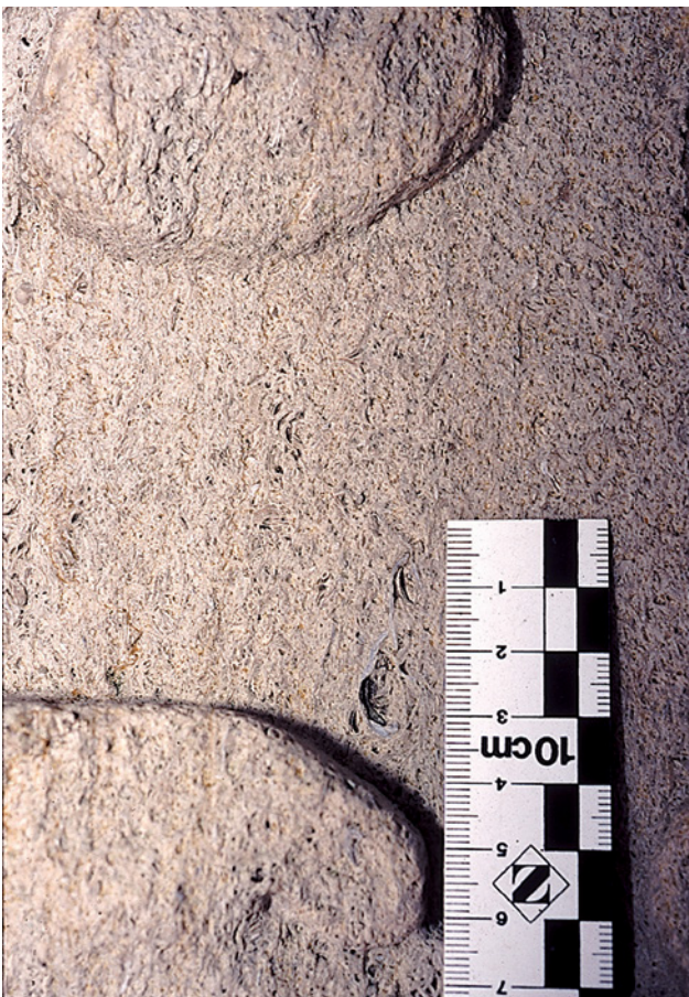
Abb. 4 Grobporöse Oberfläche eines Muschelkalkes, die aufgrund ihrer Struktur für eine Hydrophobierung mittels Imprägnierung völlig ungeeignet ist.
