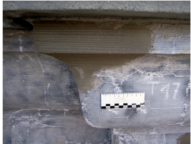
Abb. 12 Vortest zur Betonsanierung – Bemusterung einer Sika-Mörtelantragung (SikaQuick 506 FG) am Hauptkranzgesims, Nordturm Westseite
