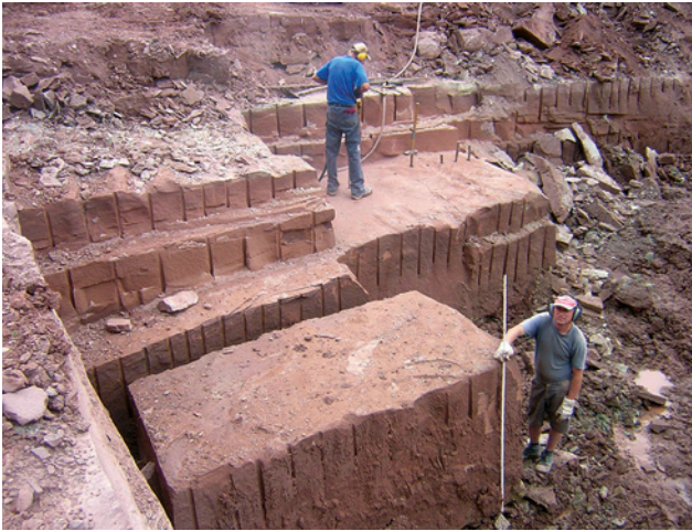
Abb. 4 Abbau von Seedorfer Plattensandstein (Oberer Buntsandstein des Nordschwarzwalds) im Steinbruch Vierhäuser der Fa. Roth, Foto: Fa. Roth, Seedorf
