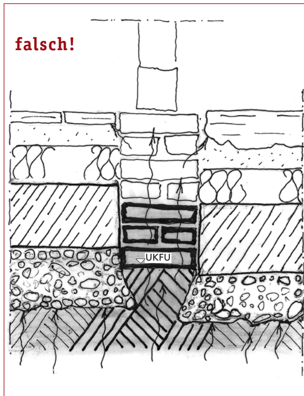
Abb. 23: So bitte nicht! Grundbruchgefahr! Aushub ist tiefer als UKFU
