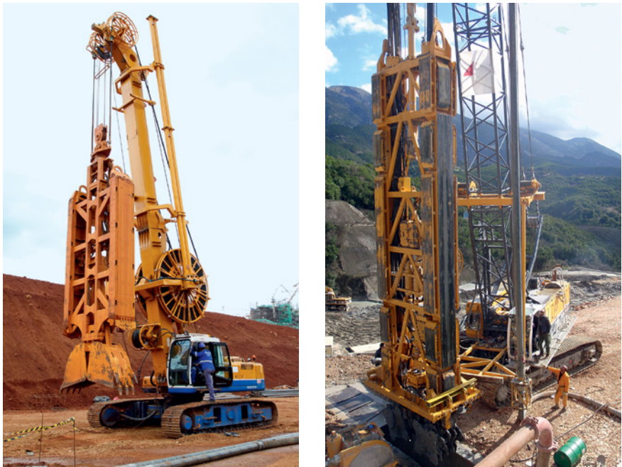
Bild 36 ▪ Aushubwerkzeuge: Schlitzwandgreifer (links) und Schlitzwandfräse (rechts)
