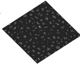
Fig.6: T_{\text{melt}} : 200°C; T_{\text{mold}} : 30°C; V_{\text{iny}} : 100cm 3 /s P_{\text{hold}} : 400bar Sz: 136.601μm; mr: 19.4%; V_m : 4.72 \times 10^9 \mu\text{m}^3
