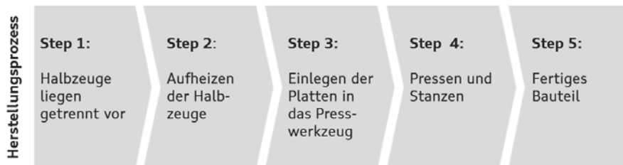
Bild 5: Herstellung eines LWRT-Organoblech-Verbunds
