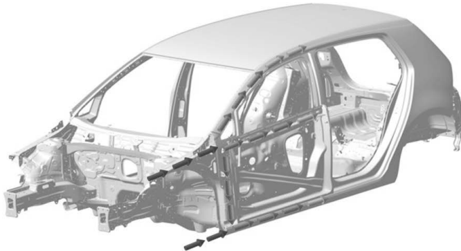
Bild 4: Computer-Aided-Design Modell des Karosserie-Rohbaus eines Golf 7 mit exemplarischen Lastpfaden während eines Front-Crashes mit geringer Überdeckung – Englisch: Small-overlap front crash.
