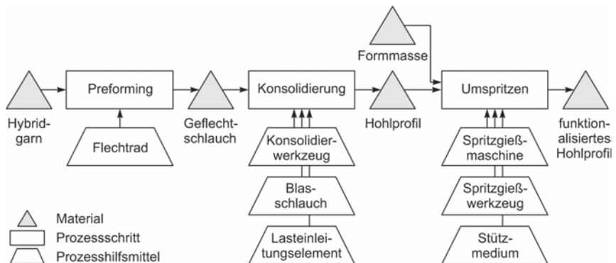
Bild 1: Prozesskette zur Herstellung komplex geformter topologischer Hohlprofile und anschließender spritzgießtechnischer Funktionalisierung
