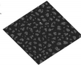
Fig.7: T_{\text{melt}} : 200°C; T_{\text{mold}} : 80°C; V_{\text{iny}} : 500cm 3 /s; P_{\text{hold}} : 600bar. Sz: 144.731μm; mr: 33.64%; V_m : 9.12 \times 10^9 \mu\text{m}^3
