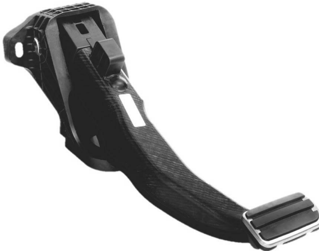
Bild 3: Fußhebelwerk des Porsche Panamera G2 in Endlosfasertechnologie
