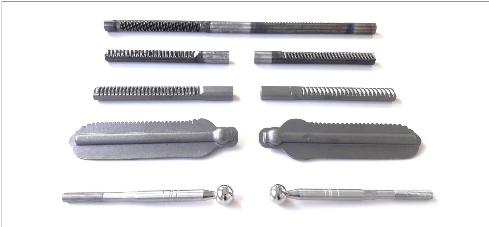
Bild 10 a) Schmiedeprozess, b) spanende Nachbearbeitung, c) Spurstange. Grafik: Fraunhofer IWU
