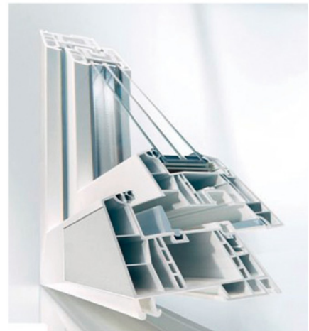
Abb. 31: Kunststoffprofil mit faserverstärktem Kunststoff ohne Metall-Tragprofil und alternativem Einsatz von Dämmeinlagen im Profil U f ca. 0,9W/(m 2 K)
