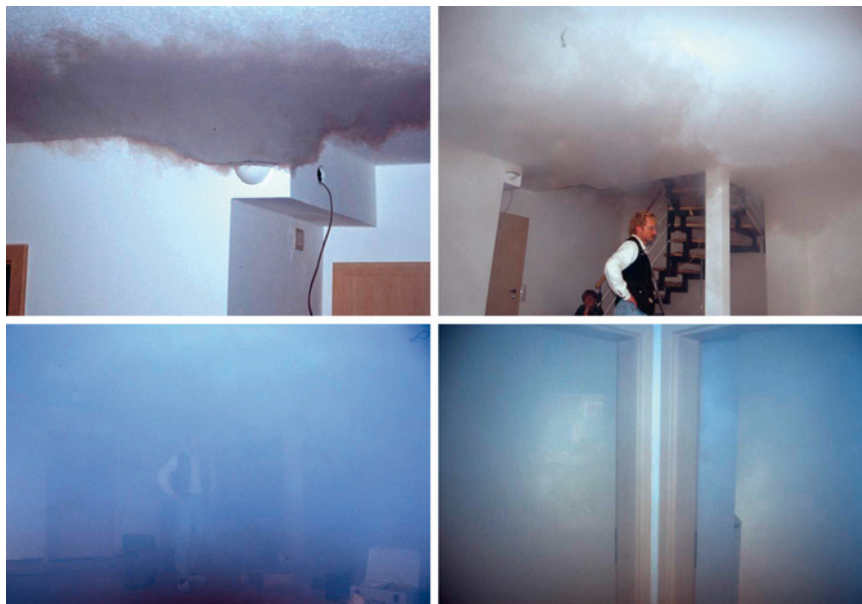
Abb. 62: Visualisierung der Luftströmung bei einem Weitwurfventil mittels eines Nebelversuchs: Der Coanda-Effekt führt den Luftstrom während der ersten Meter entlang der Decke, danach ist die gleichmäßige Luftverteilung bei minimaler Luftgeschwindigkeit ohne Zugempfinden gewährleistet.
