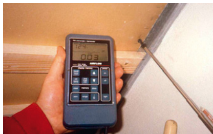
Abb. 41: Anschluss einer Abdichtungsbahn an das Mauerwerk: Überprüfung beim Blower-Door-Test mit dem Anemometer
