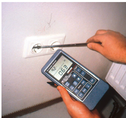
Abb. 45: Steckdosen-„Tornado“ beim Blower-Door-Test
