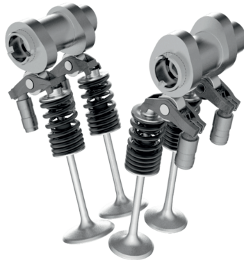
Bild 7: Ventiltrieb des 718 4,0 Liter Saugmotors
