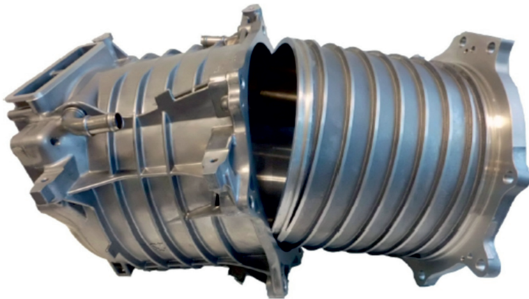
Bild 1: Assembledes E-Maschinengehäuse mit separat gegossenem Innen-Statorträger sowie Außengehäuse (BMW i3); Fertigung im Druckguss.
