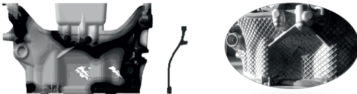
Bild 11: Abbildung des thermischen Füllzustandes am 3 Millimeter starken Kettenkastenbereich mit illustriertem Querschnitt aus der Simulationsvernetzung, sowie Ausschnitt der Ansicht eines realen Gussteiles.
