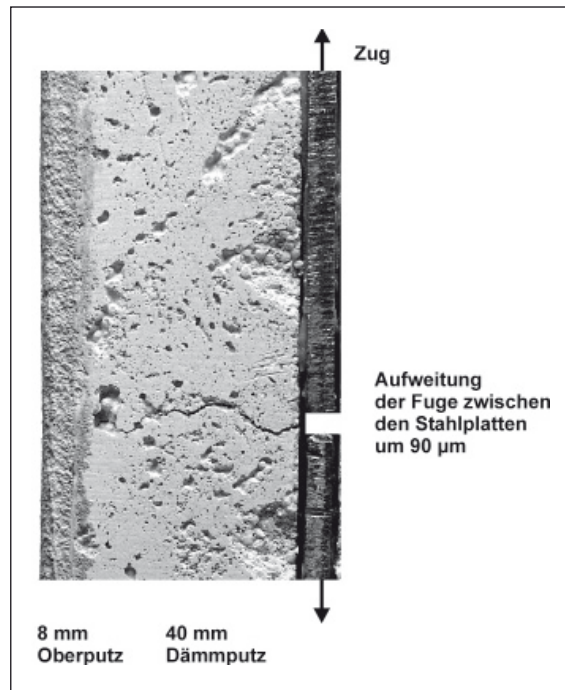
Bild 50: Foto eines Scherzug-Prüfkörpers von der Seite aus aufgenommen, bestehend aus 40 mm EPS-Dämmputz und 8 mm Oberputz (nur eine der beiden gleichartigen Putzproben). Die Rissbreite nimmt zum Oberputz hin ab.
