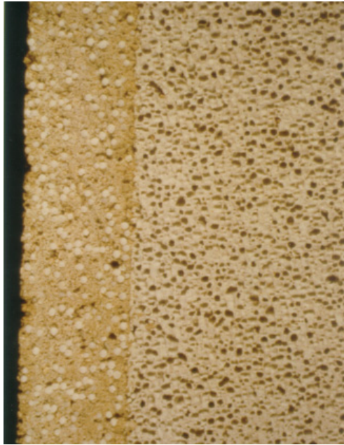
Bild 44: Schnitt durch Porenbeton mit aufgebrachtem Leichtputz. Die Strukturähnlichkeit zwischen dem Putzgrund Porenbeton und dem Putz ist optisch erkennbar.
