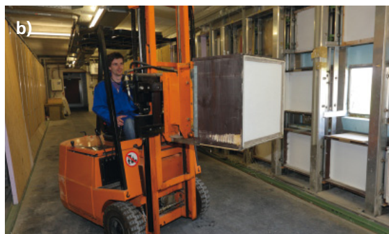
Bild 30 a + b: Neuer Versuchsstand. a) Außenansicht, b) Innenansicht. Mithilfe des Gabelstaplers können die Wandproben auf eine Waage gesetzt werden.
