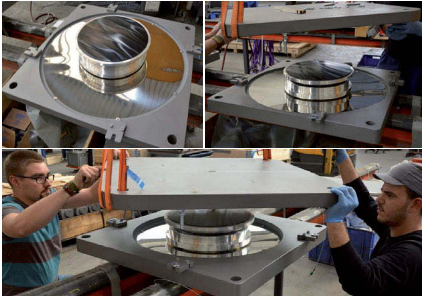
Bild 1: Zusammenbau der SIP-Adaptives #2 (oben) und #3 (unten) im Werk München
