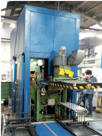
Bild 4: Links: Stanzmaschine in Einhausung, rechts: Zeitverlauf der Schwingschnelle auf der Bodenplatte (Mittelwert aller vier Sensoren), Variante V02
