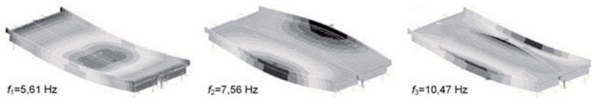
Bild 7: Rechnerisch ermittelte Eigenfrequenzen und –formen mit optimierten Parametern – Optimierung mit Bezug auf die kombinierte Modalanalyse (mit Impulshammer)
