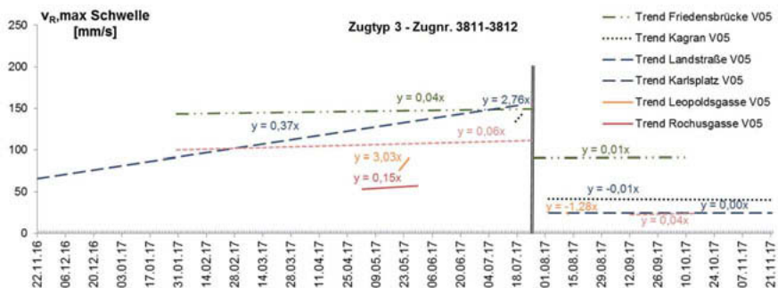
Bild 7: Langzeitverlauf und Anstieg der Erschütterungsemissionen eines Zuges auf verschiedenen Messanlagen. Zugwartung am 25.07.2017 durchgeführt.
