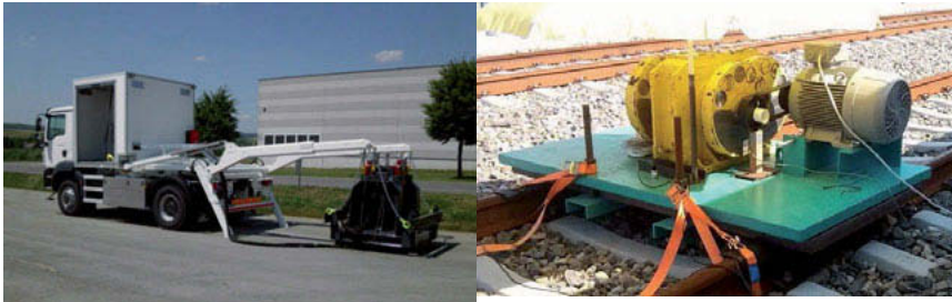
Bild 3: (links) Hydraulischer Erreger MoSeS [AIT]; (rechts) mechanischer Unwuchterreger [TU Wien]
