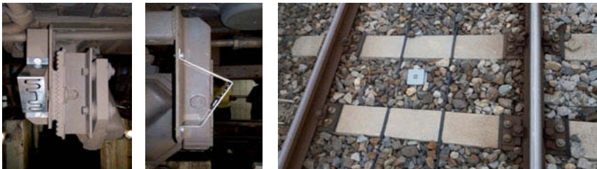
Bild 3: Am Zug instrumentierter RFID-Transponder (links und mitte) und Ausleseantenne (rechts).
