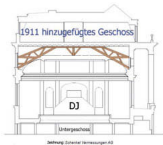
Bild 4: Das Stahlfachwerk des 1911 oben hinzugefügten Geschosses ist heute das primäre Tragelement des Daches ([1]).
