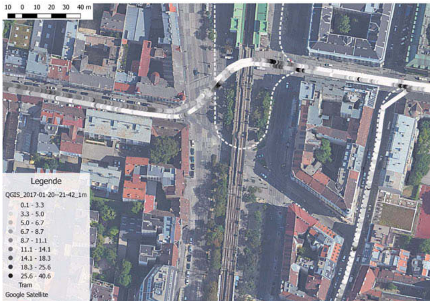
Bild 2: Darstellung der Standardabweichung der Schwingbeschleunigungen am Radlager innerhalb 1 m Bins. Überfahrt von Weichen und Kreuzungen deutlich erkennbar
