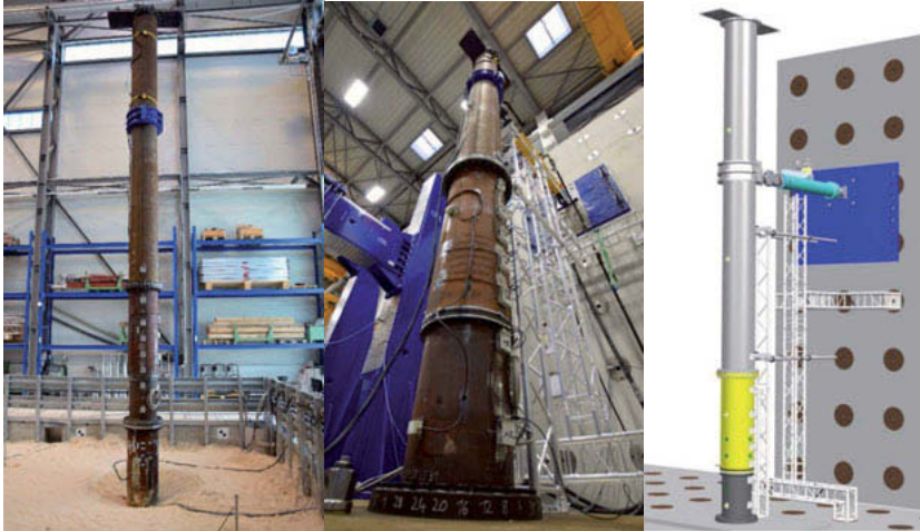
Bild 2: Messaufbau des Versuchs in der Grundbauversuchsgrube (links) und im Spannungsfeld (Mitte und rechts) [3].
