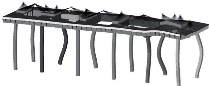
Bild 4: Ergebnis der Modalen Analyse – Eigenform bei 50 Hz
