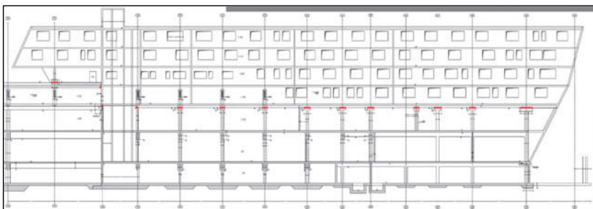
Längsschnitt durch das Gebäude mit PUR Lagern auf Stützenkopferweiterungen.
