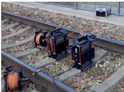
Bild 2: Long Stroke Shaker APS 400; Zwei Shaker bei gleichzeitiger Erregung in Gleisachse
