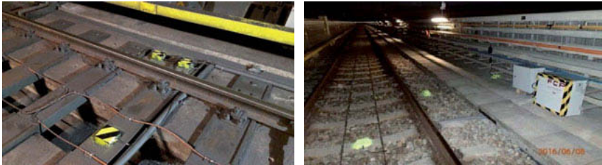
Bild 2: Instrumentierte Sensoren im Gleisbereich.
