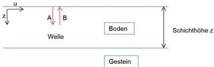
Bild 2: Bildliche Darstellung der Bezeichnungen für die Wellengleichung (in Anlehnung an [4])
