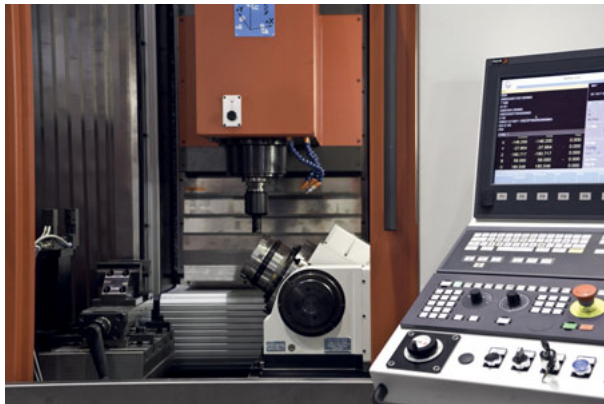
Abbildung 7.1: Portalfräsmaschine mit Dreh- und Schwenkeinheit [15].
