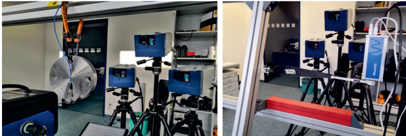
Bild 61: Links: Aufbau zur experimentellen Modalanalyse eines Flansches; die Struktur mit freien Randbedingungen wird durch einen Shaker zwischen 4-12 kHz angeregt und die Systemantwort über 3D-LDV erfasst. Rechts: Aufbau zur experimentellen Modalanalyse eines Rotorblatts; die einseitig befestigte Struktur wurde durch den automatischen Modalhammer vom Typ WaveHit angeregt und die Systemantwort über 3D-LDV erfasst.
