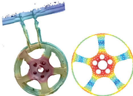
Bild 70: Eigenschwingungsform der dritten Mode bei 1215 Hz der Fahrzeugfelge; Links: mit elektromechanischen Sensoren, 15 Messpunkten und dem Ergebnis der Arbeit; Rechts: Messung mit dem Laser-Doppler-Vibrometer an 454 Punkten
