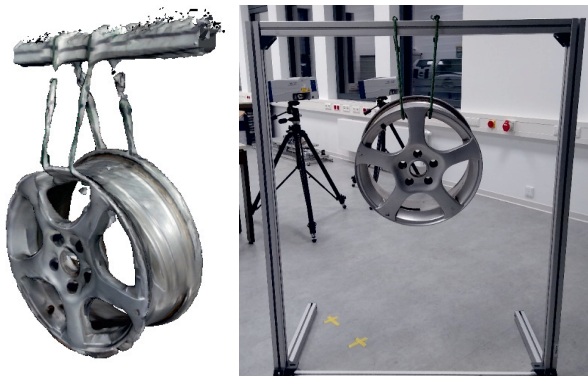
Bild 52: Links: 3D-Rekonstruktion (106020 Dreiecke) einer Autofelge mit der Intel Real Sense D455 Tiefenkamera und dem Kinect Fusion-Algorithmus; Rechts: Bild der Struktur
