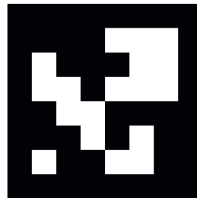
Bild 42: Beispiel eines ArUco-Markers der Größe 6-mal-6 Bits
