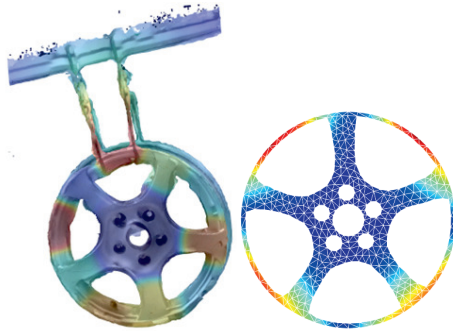
Bild 69: Eigenschwingungsform der ersten Mode bei 388 Hz der Fahrzeugfelge; Links: mit elektromechanischen Sensoren, 15 Messpunkten und dem Ergebnis der Arbeit; Rechts: Messung mit dem Laser-Doppler-Vibrometer an 454 Punkten
