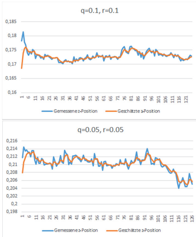
Bild 56: Gegenüberstellung der Zeitverläufe gemessener und geschätzter z-Position für unterschiedliche Einstellungen des erweiterten Kalmanfilters
