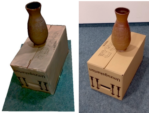
Bild 51: Links: 3D-Rekonstruktion (269699 Dreiecke) einer Vase mit der Intel Real Sense D455 Tiefenkamera und dem Kinect Fusion-Algorithmus; Rechts: Bild der Struktur
