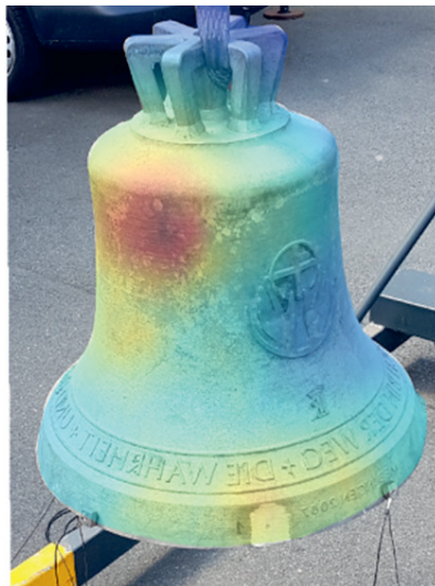
Bild 29: Echtzeitschwingungsbild einer Kirchenglocke mit Sensordatenfusion - AR-Visualisierung der Betriebsschwingform mit farbcodierten Sensorwerten, aufgenommen mit elektromechanischen Sensoren und den Verfahren dieser Arbeit
