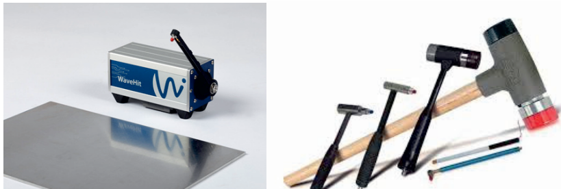
Bild 9: Links: Automatischer Modalhammer vom Typ WaveHit, Quelle: [18]; Rechts: unterschiedliche, handgeführte Modalhämmer der Firma PCB Synotech, Quelle: [19]
