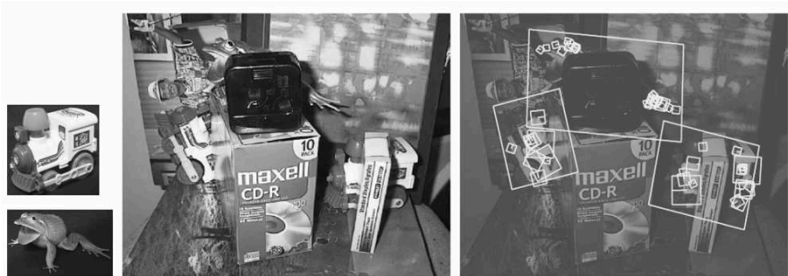
Abbildung 8: Anwendungsbeispiel Instance Recognition: Automatisiertes Wiederfinden von Objekten in einem Bild
