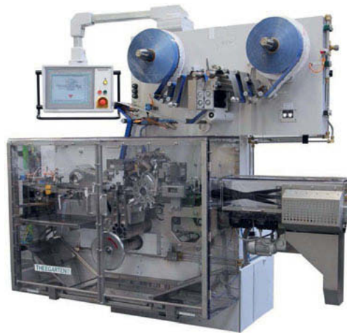
Bild 2: Verpackungsmaschine U1-C zum Einschlag kleinstückiger Packgüter
