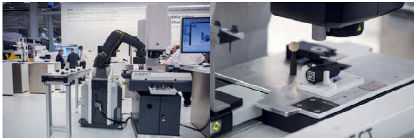
Bild 5: Multisensor-Koordinatenmessgerät mit Roboterbeladung II: Der Roboter nimmt das Werkstück auf, um das Messgerät zu beladen (links). Das Werkstück befindet sich in der Vorrichtung auf der Palette bereit zur Messung (rechts)
