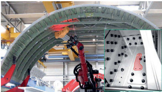
Bild 1: Robotergeführtes Sensorsystem für die flexible Montageprüfung einer Rumpfschale und Bildausschnitt mit eingblendetem Fehlbauteil.
