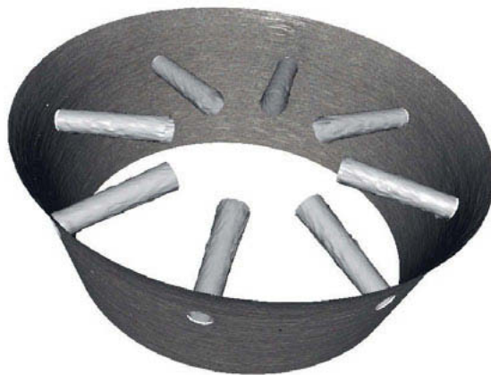
Bild 2: Gemessener 3D Datensatz eines Teils der Einspritzdüse inklusive der 8 Einspritzlöcher.
