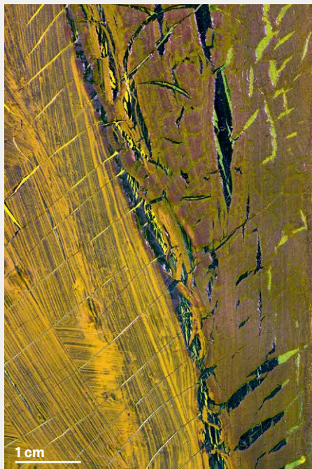
Abb. 1.10 Detail Risse, Haare der Figur im Profil. Spannungsbedingte, feine Risse, fein verästelte Schwundrisse in der dünnen schwarzen Schicht und weit geöffneten Schwundrisse in der braunen Farbschicht sind erkennbar.
