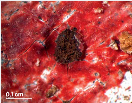
Abb. 5.11 Detail Schadensbild (Stereomikroskop). Das austretende Material variiert in Farbigkeit, Konsistenz und Opazität. Das dunkle Material links im Bild ist pudrig und opak, das hellbraune Material weist einen besseren Zusammenhalt der Konglomerate auf und wirkt glasig.
