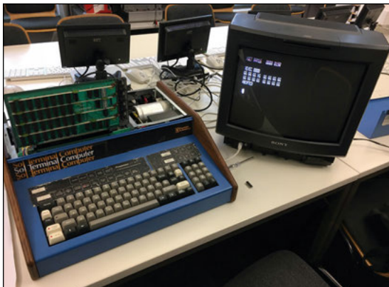
Abb. 12: Zu Testzwecken wurde ein RAM-Baustein aus der Karte gezogen und ein Speichertest durchgeführt. Das »XG« im oberen linken Buchstabenblock zeigt den fehlenden Baustein.
