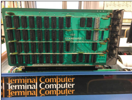
Abb. 11: Zu Testzwecken kann eine Karte von oben in den S-100-Bus gesteckt werden. Hier wird die scheinbar defekte RAM-Karte getestet.
