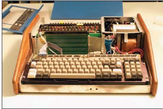
Abb. 5: Der geöffnete Sol-20.
