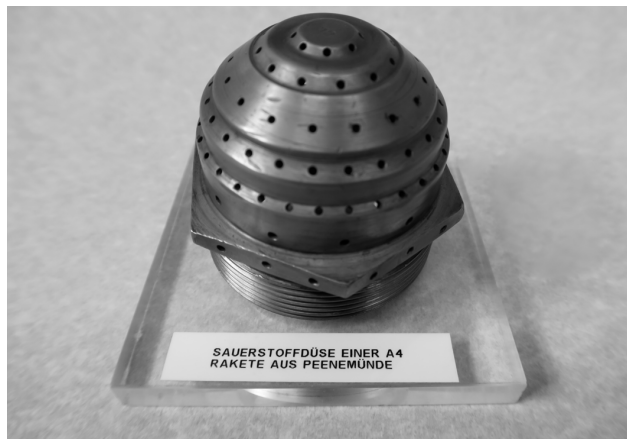
Abb. 2: In den frühen Ausstellungen des Museums wurden verschiedene Fundstücke aus dem Gelände präsentiert. Dazu zählte auch die hier abgebildete Sauerstoffdüse eines A4-Triebwerks aus dem Jahr 1943. Urheber war ein ehemaliger Lehrling des Versuchsserienwerks, der die Objekte nach 1989 im Gelände ausfindig machte und aushob, auf Acrylglas befestigte und teilweise an ehemalige Mitarbeiter der Versuchsanstalten und andere prominente Besucher verschenkte. Quelle: Constanze Seifert, Technische Universität Braunschweig, 2017
