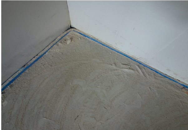
Bild 16 ■ Absandende Oberfläche nach der Drahtbürstenprüfung
