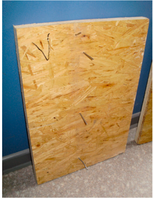
Bild 72 ■ Die OSB-Platten wurden gegen die Empfehlung des Herstellers auf den Dielenboden genagelt.
