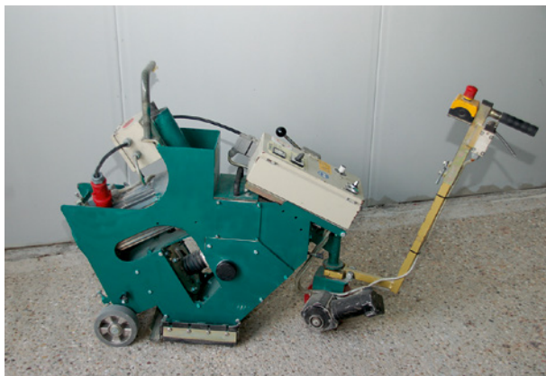
Bild 22 ■ Vorbereitung eines geglätteten Betonuntergrunds mittels Kugelstrahlen
