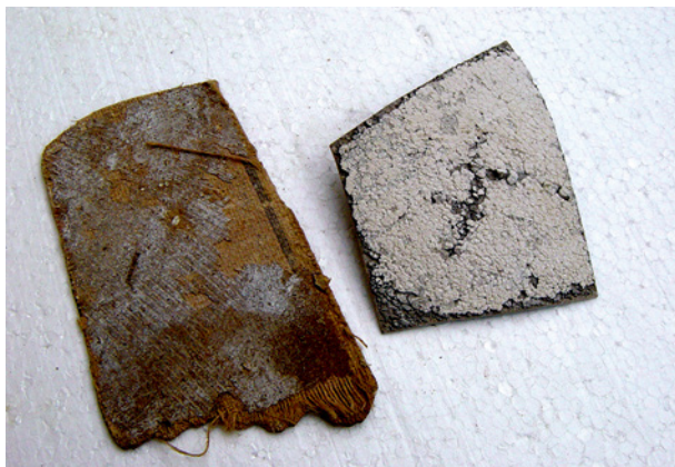
Bild 17 ■ Spachtelmassenablösung aufgrund zu geringer Oberflächenfestigkeiten
