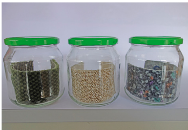
Bild 104 ■ Kostengünstige Vorprüfung bei Geruchsbeanstandungen mit einfachen Einweck- oder Schraubdeckelgläsern
