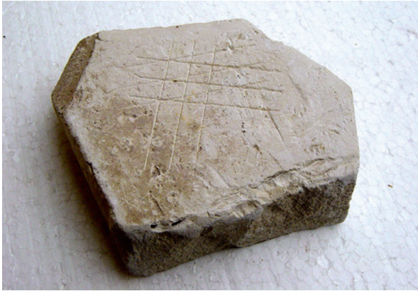
Bild 15 ■ Gitterritzprobe an einem alten Anhydritestrich
