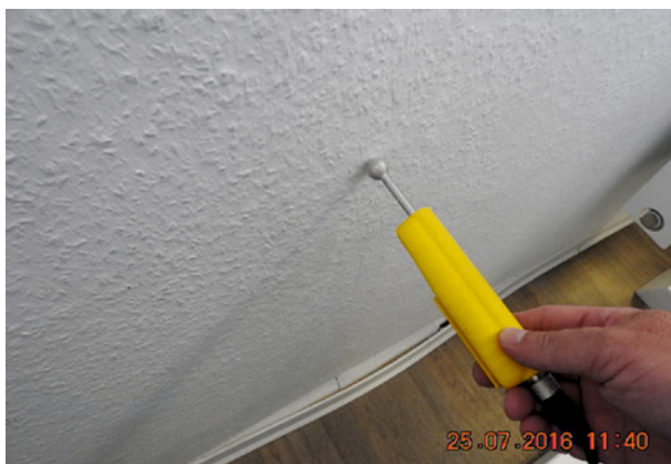
Bild 61 ■ Messung der Wandfeuchte mittels elektrischen Widerstandsverfahren
