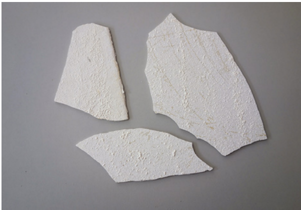
Bild 77 ■ Abplatzen der Spachtelmasse aufgrund von Reststäuben
