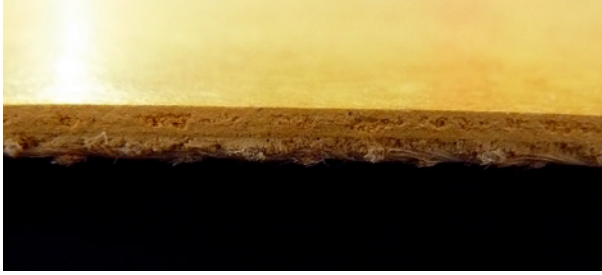
Bild 2 ■ Schnitt durch einen Linoleumbelag. An der Unterseite ist das Trägermaterial aus Jutegewebe erkennbar.
