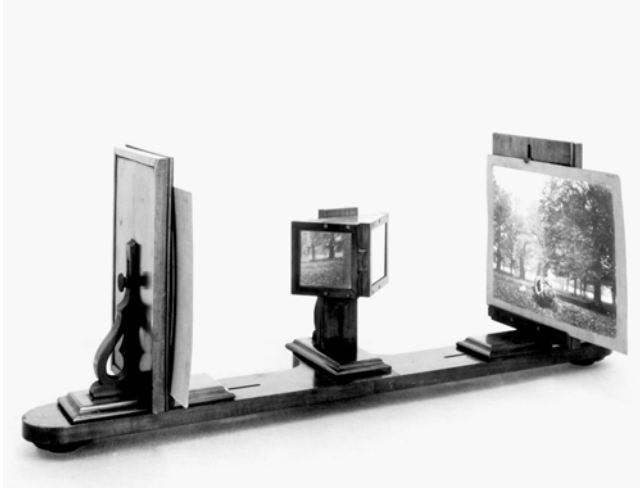
Abb. 25: Reflexionsstereoskop von Charles Wheatstone, London, ca. 1850.
