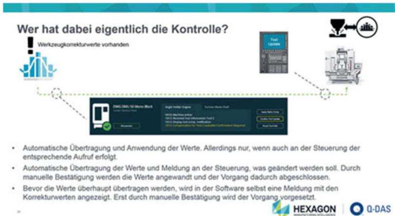
Bild 9: Korrekturwerte visualisieren und an Werkzeugmaschine übertragen
