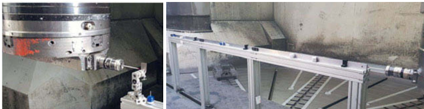
Bild 4: a) Tasterkalibrierung an einem 25 mm Parallelendmaß. b) Zwei-Punkt-Messung in X-Richtung an drei 1-Meter-Endmaßen. Der Aufbau kann flexibel um 1 m Schritte erweitert oder verkürzt werden. Ein ähnlicher Aufbau wurde auch für die Zwei-Punkt-Messung in Z-Richtung verwendet.
