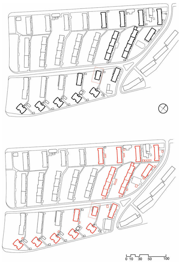
Abb. 8: Lagepläne Bestand – Nachverdichtung, Fritz-Kissel-Siedlung
