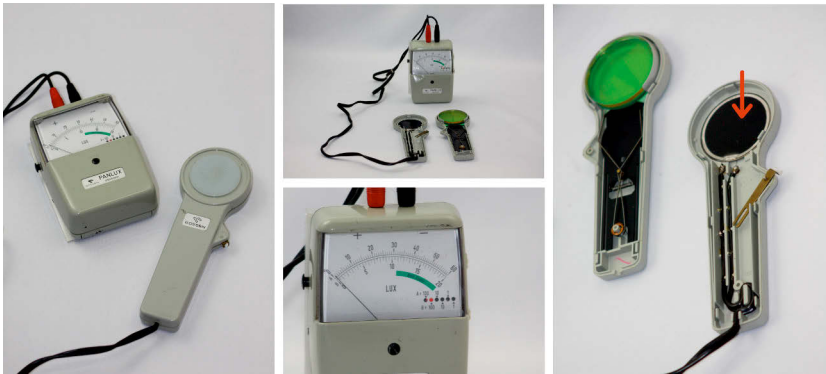
1.5: Gossen's PANLUX Electronic Luxmeter. Photo: Grazielle Lautenschlaeger; Source: Media Archaeological Fundus/Institut für Medienwissenschaft/Humboldt-Universität zu Berlin.
