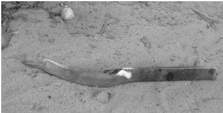
Abbildung 3: Schabeisen, das aus einer Feile geschmiedet wurde
