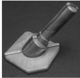
Schmiedeteil nach Zerteilen
