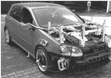
Bild 1: Messfahrzeug inkl. Anordnung zu Aggregatbewegungsmessung (links) und Anordnung der Seilzugpotentiometer an den beiden Messpunkten oben (rechts) [2]
