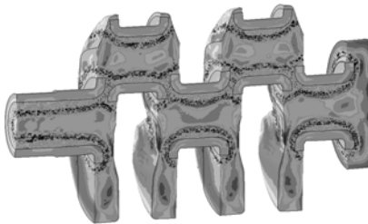
Bild 9: Eigenspannungen beim induktiven Aufheizen
