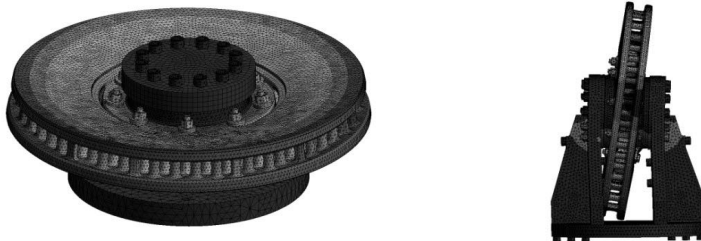
Bild 4: Schirmmode der axial eingespannten Wellenbremsscheibe (links) und Scheibenkippen 1 der radial eingespannten Wellenbremsscheibe (rechts)
