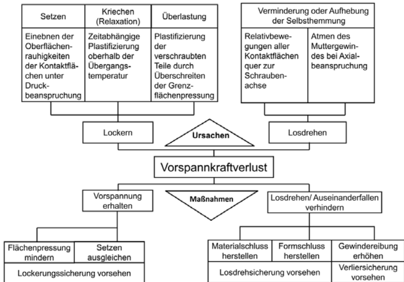
Bild 3: Wirkmechanismen und Maßnahmen von Lockern und Losdrehen
