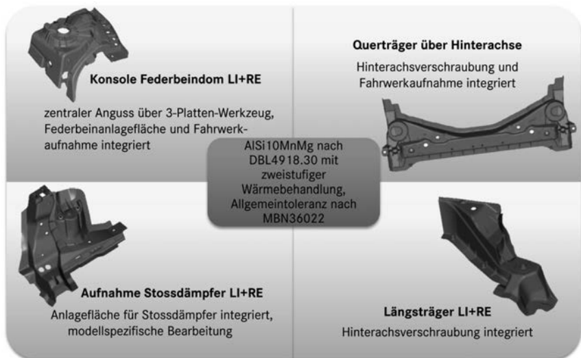
Bild 2: Teilefamilie Aluminium-Strukturguss in der neuen C-Klasse und im GLC
