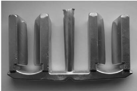
Bild 7: Gussteil Bolzenprobe aus AlSi7Mg0,3 in Anlehnung an (Engler, Ellebrock 1974) [3]
