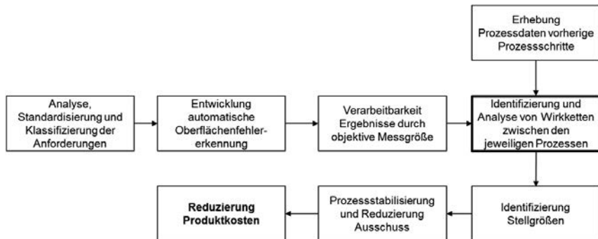
Bild 2: Vorgehensweise zur Prozessstabilisierung durch automatisierte Erkennung von Oberflächenfehlern in der Gesamtprozesskette der Aluminium-Druckguss-Bearbeitung
