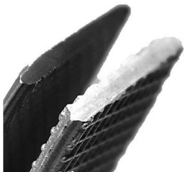
Bild 23: Wandstärkenvergleich zwischen Standard-Hilfsrahmen (rechts) und Dünnwand-Derivat (links)
