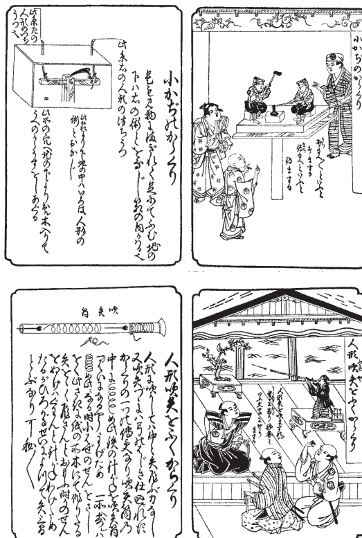
Abb. 4: Zwei Darstellungen von Karakuri-Puppen aus dem Karakuri kinmō kagami-kusa (Sammlung von Darstellungen verschiedener Karakuri-Figuren) von 1730. Oben rechts zwei Schmiede, die ihre Hämmer auf einen Amboss schlagen mit der dazugehörigen einfachen Beschreibung der Mechanik (oben links), unten rechts eine Karakuri-Figur, die den Eindruck vermitteln soll, dass sie mit einem Blasrohr einen Pfeil abschießt. Aus der Darstellung der Mechanik (unten links) wird aber deutlich, dass es ein simpler Federmechanismus ist, der den Abschuss auslöst. Quelle: KIKUCHI Toshiyoshi (Hg.), Zufu – Edo jidai no gijutsu – jō (Illustrierte Geschichte der Edo-Zeit, Bd. 1), Tōkyō: Kōwa Shuppan 1988, S. 613f.
