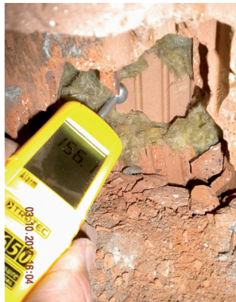
Abb. 1: Mit einer elektronischen Widerstandsmessung kann man erste Kontrollmessungen durchführen und Indizien gewinnen, ob der Untergrund noch erhöhte Feuchtigkeit (in der Abbildung 159 Digits) aufweist oder nicht. Je nachdem kann man dann mit noch genaueren Messmethoden nachmessen. Das ungewöhnlich gute Stehvermögen des frisch applizierten Nassmörtels verleitet dazu, große Schichtdicken (bis 30 mm) in einem Arbeitsgang aufzubringen.
