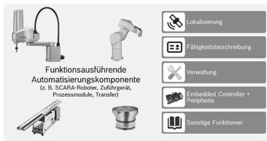
Bild 1: Die mechatronischen Objekte (MO) repräsentieren eine Montagefunktion und beinhalten sämtliche, für den eigenständigen Betrieb notwendigen Komponenten [2]
