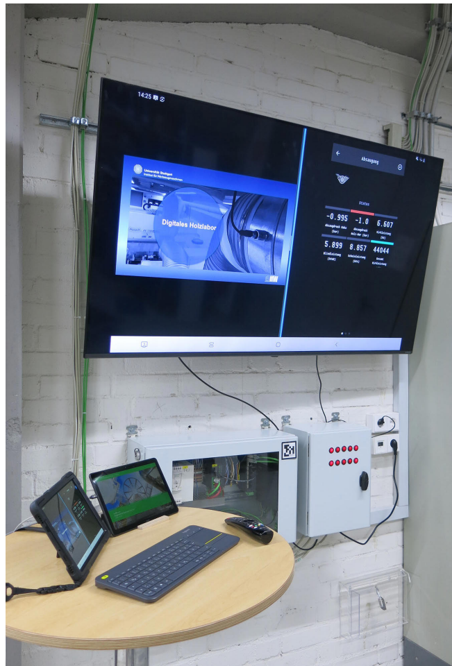
Bild 5. Infopoint des SmartLabs mit zentraler Datenerfassungseinheit zur Visualisierung der Maschinenzustände und Prozessdaten. Foto: IfW, Universität Stuttgart
