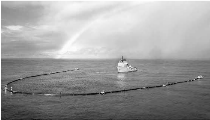
Abb. 5 Ocean Cleanup System 001 , die 2018 für einige Monate im GPGP in Betrieb genommene Drifter-Sammeleinrichtung
