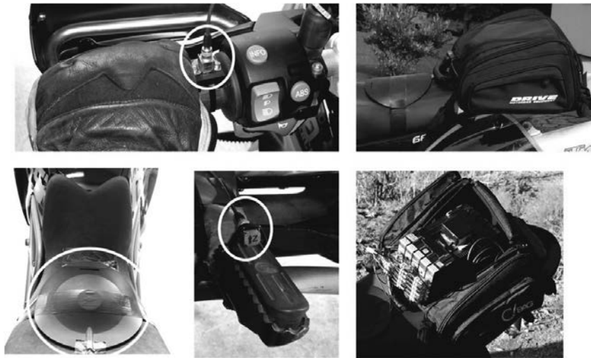
Bild 3: Sensorpositionen an Lenker (oben links), Sitzbank (unten links) und Fußrasten (unten Mitte); Verstärker und Datenaufzeichnungsgeräte in Sitzbanktasche (rechts)
