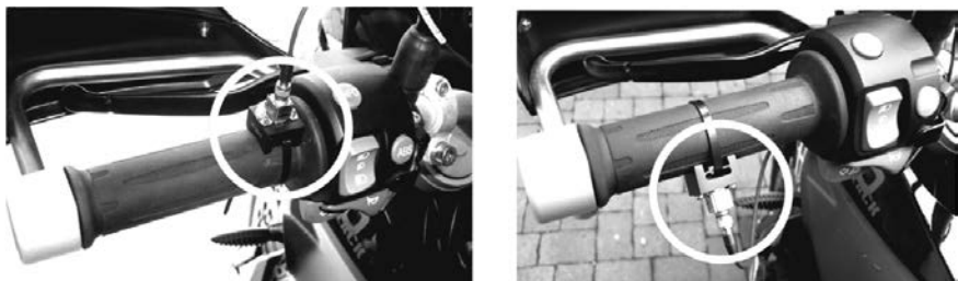
Bild 5: Sensor am Handgriff an Griffinnenseite (Bild links) und Griffmitte (Bild rechts)
