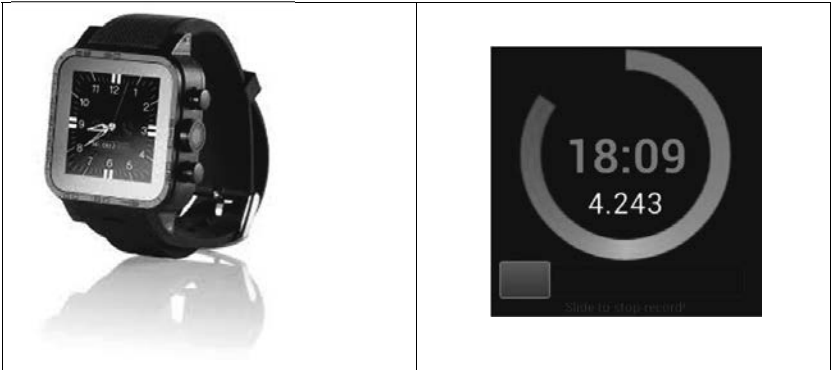
Bild 3: Smartwatch und User-Interface der AGIS – Applikation mit farblicher Darstellung der aktuell erreichten Tages-Vibrationsdosis
