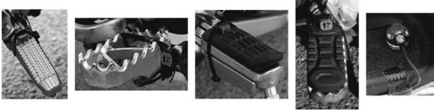
Bild 4: Beispiele zur Applikation der Beschleunigungsaufnehmer an verschiedenen Fußrasten/-plattformen.
