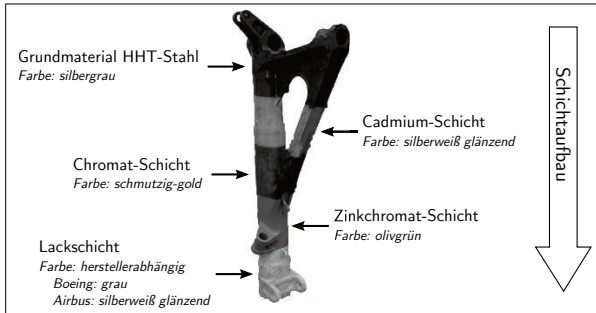
Abbildung 2.21.: Aufbau der Oberflächenbeschichtung des Mainfitting eines Fahrwerks mit einem Grundmaterial aus HHT-Stahl
