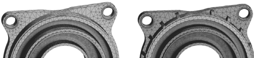
Bild 6: Finite-Elemente-Analyse des Entwurfs ohne und mit Verrippung
