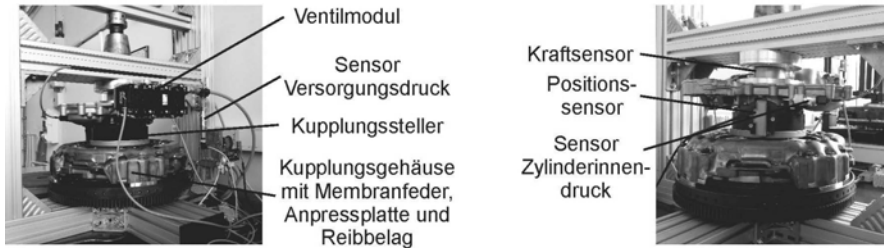
Bild 1: Prüfstands Aufbau zur Identifikation von Systemparametern und zur Validierung modellbasierter Regelungskonzepte.
