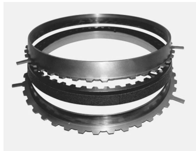
Bild 9: Reibpaket des alternativen Schaltelements TorqueLINE nach Prüfläufen
