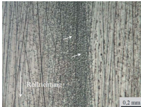
Abbildung 3-20: Umlaufende Partikeleindrückungen durch harte, in den Wälzkörpern feststeckende Partikel
