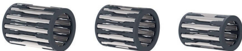
Abbildung 7-1: Radialnadelkränze: links unverändertes Lager, mitte: axiale Bauhöhe um 12 % reduziert, rechts: reduzierte Nadelanzahl und Teilkreisdurchmesser um 20 % reduziert
