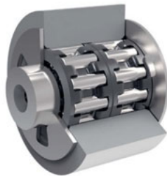
Abbildung 3-4: Anordnung des Prüflings und der Nadelkranze im Prüfaufbau
