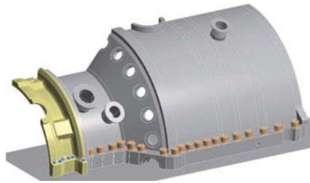
Bild 8: NX CAD Model des Außengehäuses mit Schrauben als Ausgang für FEA
