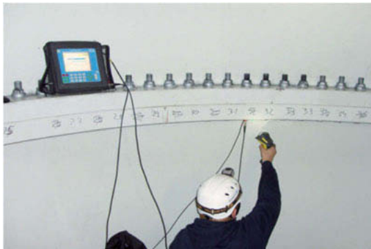
Bild 6: Messung der Montagevorspannkraft F_M mit dem USB-System (ITH)
