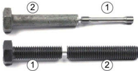
Bild 4: ① Zug- und ② Scherprobe aus ein und derselben Schraube
