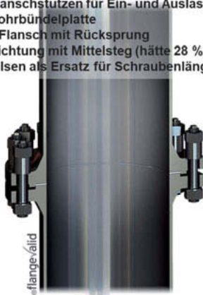
Bild 3: Unterschied der gebauten zur nach DIN EN 1591-1 gerechneten Flanschverbindung.
