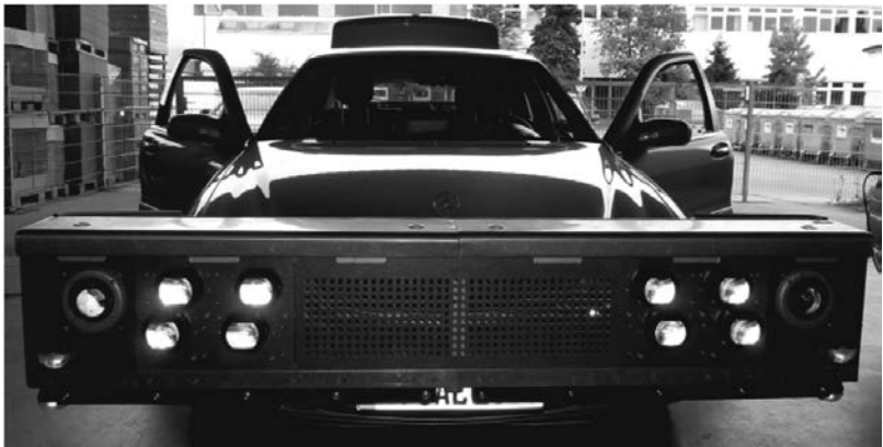
Bild 2: Foto des Versuchsfahrzeugs mit vier Satz Bi-eLight.
