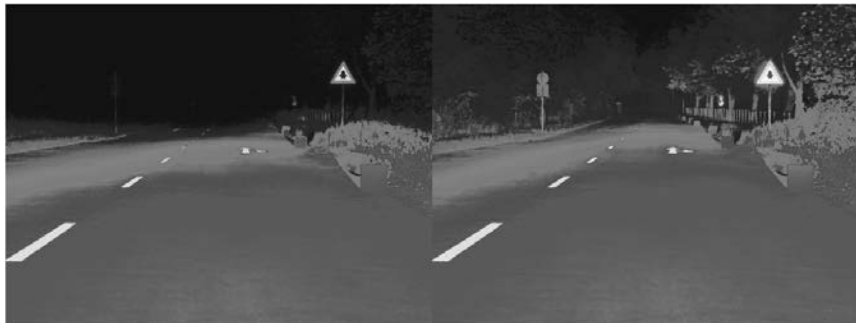
Bild 3: Leuchtdichtedarstellung einer Abblend- und Fernlichtverteilung in Falschfarben. Stark überhöhte Leuchtdichte im Bereich des Verkehrszeichens bei Fernlicht.
