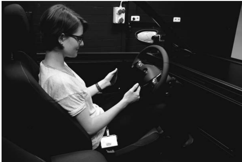
Bild 2: Aufbau der Sitzkiste mit LED Leisten und Tablet für visuelle Nebenaufgabe
