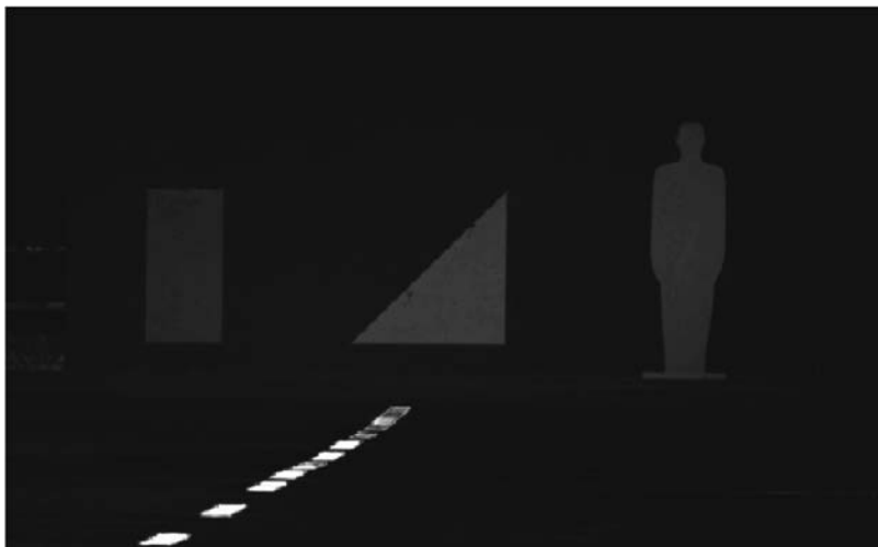
Bild 3: Versuchsszene mit verschiedene Sehzeichen vor einer schwach reflektierenden Hintergrundtafel. Kontraste (von links nach rechts): C_{\text{Viereck}} = 0,15 ; C_{\text{Dreieck}} = 0,85 ; C_{\text{Dummy}} = 0,52 .
