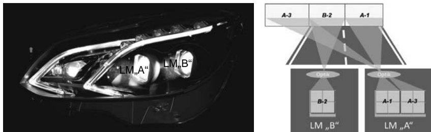
Bild 6: Foto des linken Scheinwerferprototypen (links), Lichttechnisches Funktionsprinzip Lichtquelle-Optik-Lichtverteilung am Beispiel des linken Scheinwerfers (rechts)
