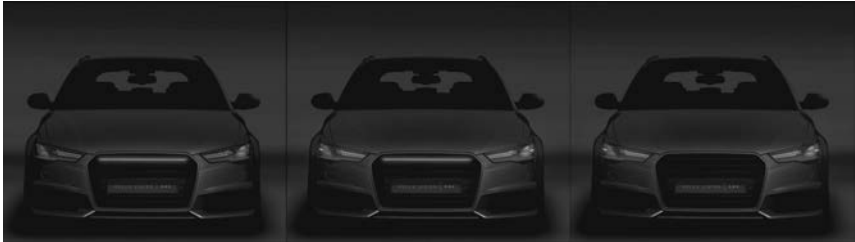
Bild 14: Animation des Fahrtrichtungsanzeigers an der Front als Warn blinker
