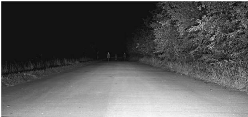
Bild 5: Bild einer typische Szene des Versuchs bei maximaler Beleuchtungsstärke von über 360 lx (gemessen auf 25 m). Abstände zwischen Versuchsfahrzeug und Personen in der Szene (von links): 165 m, 260 m, 195 m.
