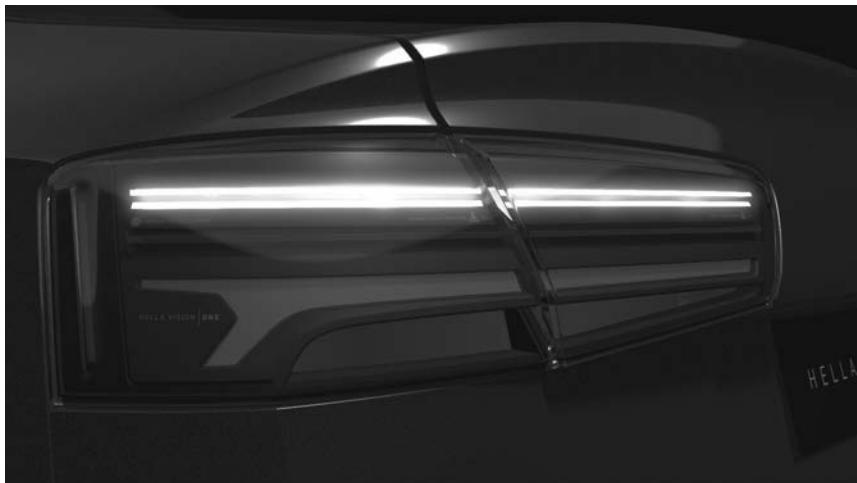
Bild 10: Rückfahrlicht (oberer Streifen) und Fahrbahnausleuchtung (unterer Streifen)
