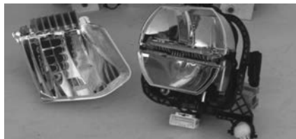
Bild 1: Zwei modern LED-Reflektion-Module, die ein Abblendlicht bzw. Fernlicht erzeugen.
