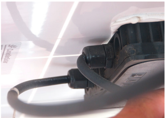
Bild 71: Überbeanspruchung der Kabeleinführung an der Anschlussdose
