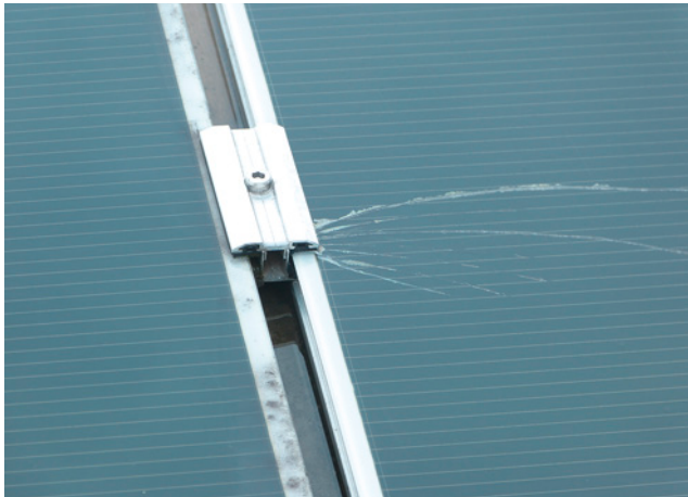
Bild 103: Spannungsriß im Glas an Klemmverbindung
