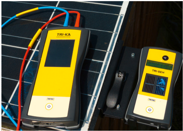
Bild 162: Kennlinienmessgerät (links) mit Einstrahlungs- und Temperatursensor (rechts)
