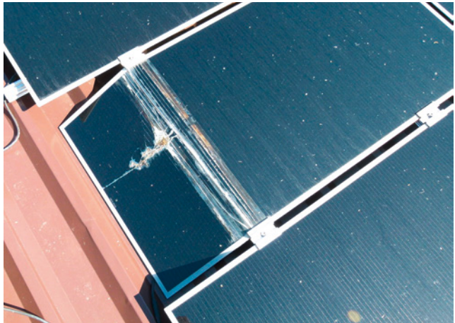
Bild 104: Glasbruch an Glas-Glas-Laminat
