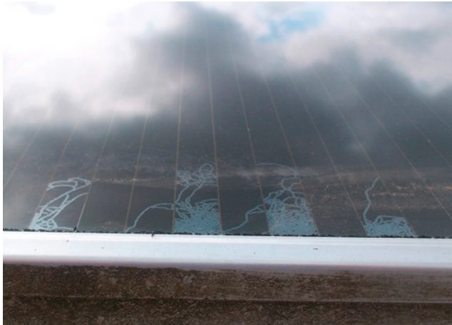
Bild 90: TCO-Schädigung im Modulrandbereich
