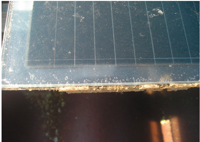
Bild 115: Blasenbildung in der Randversiegelung
