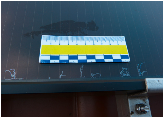
Bild 106: thermische Überbeanspruchung bei Dünnschichtmodulen (leicht verwechselbar mit »TCO-Korrosion«)
