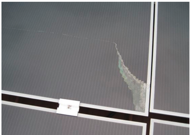
Bild 102: Spannungsrisse an Glas-Glas-Laminat
