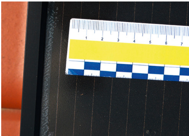
Bild 91: Beginnende TCO-Schädigung im Randbereich
