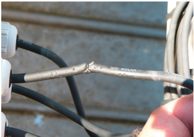
Bild 80: typischer Verbisschaden durch einen Marder
