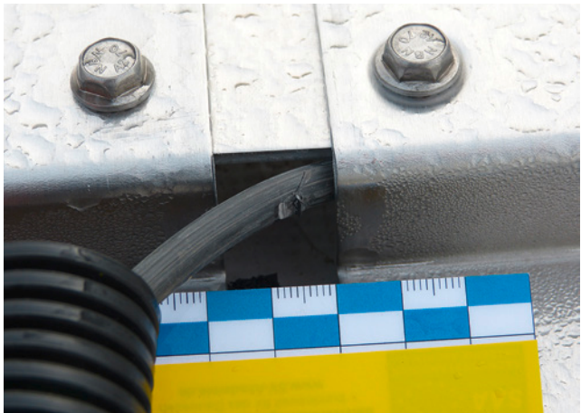
Bild 59: Einkerbungen an der Mantelisolierung der Leitung im Bereich scharfer Metallkanten
