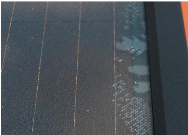
Bild 101: beginnende Delamination im Randbereich
