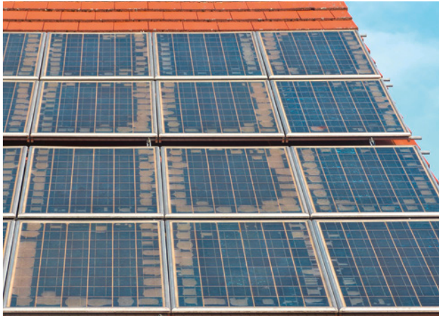
Bild 100: Delamination im Zellbereich [Quelle: Jürgen Nimis, Photovoltaikforum]
