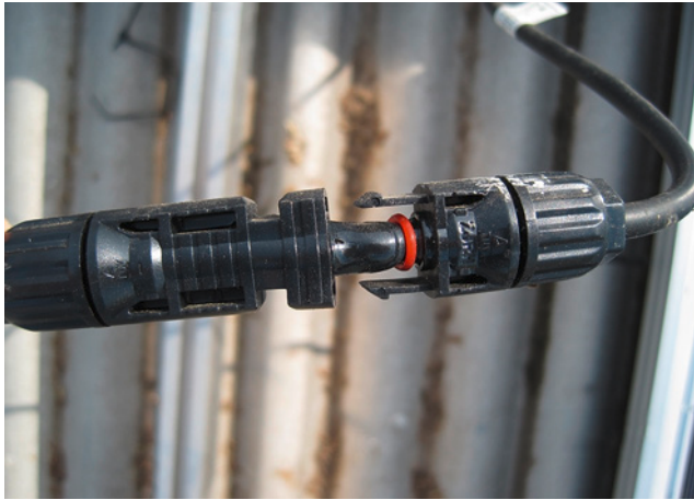
Bild 88: verschmorte Steckverbindung durch Lichtbogenbildung nach selbstständigem Lösen
