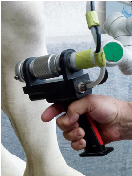
Bild 96: Laserreinigung einer Marmorskulptur aus dem Park von Schloss Sanssouci mit NdYAG Laser (Werkstattaufnahme: K. Lange)
