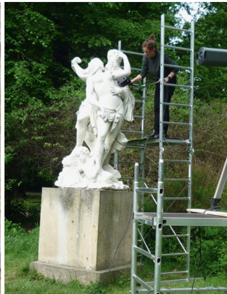
Bild 73: Handgeführter Scan vom Gerüst aus. Auch der Kamerabalken ist auf ein Gerüst gestellt.
