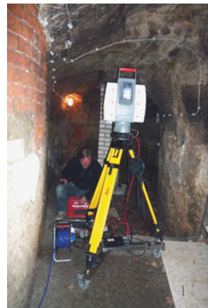
Bild 71: Terrestrischer Scanner bei der Vermessung eines Bierkellers im Kellerwald Forchheim
