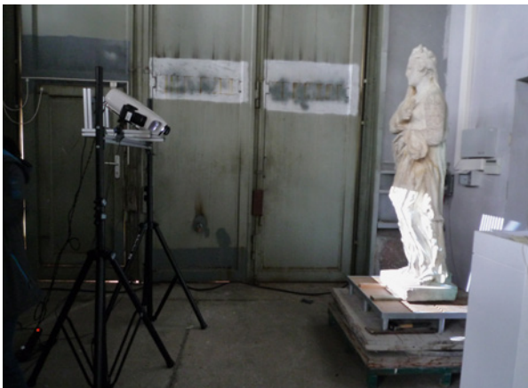
Bild 70: Messaufbau eines Streifenlicht-Scanners. Links oben im Bild sind der Beamer und die zwei Kameras erkennbar.
