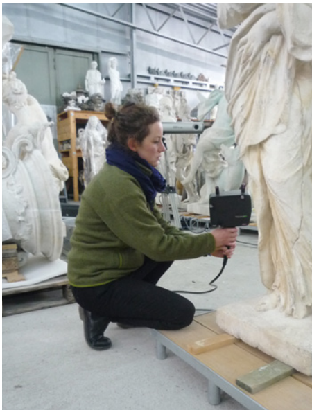
Bild 72: Der handgeführte Laserscanner in Aktion
