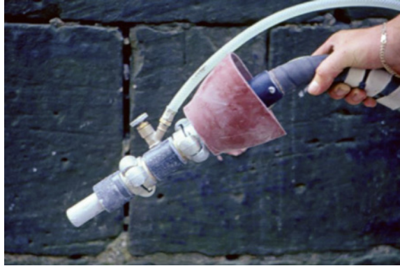
Bild 39: Partikelstrahldüse für große Flächenleistung
