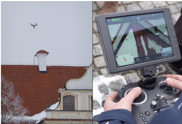
Bild 80: Drohnenbefahrung. Links: Einsatz über dem ehemaligen Kloster Thierhaupten. Rechts: Fernsteuerung mit Bildschirm, Planungsbüro Grassl (Aufnahmen: Pfanner 2019).
