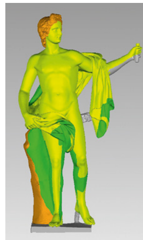
Bild 74: Apoll von den Neuen Kammern in Potsdam Sanssouci mit Kartierungen der Oberflächenrauheit
