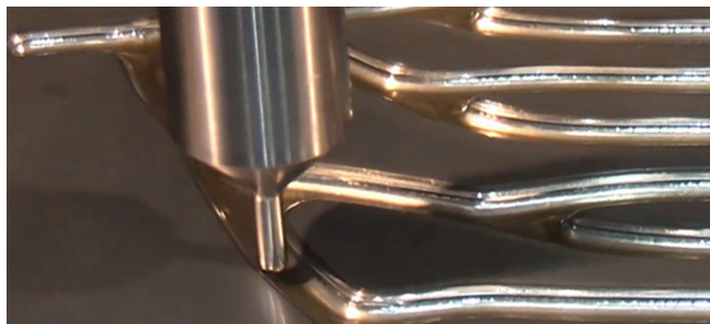
Bild 2 Inkrementelles Blechumformen mittels Umformdorn. Foto: Fraunhofer IWU [6]
